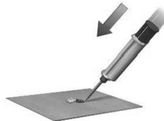
Empuje ligeramente la jeringuilla haciendo que el material efluya hasta que los dos componentes se mezclen uniformemente. No use este material inicial.
